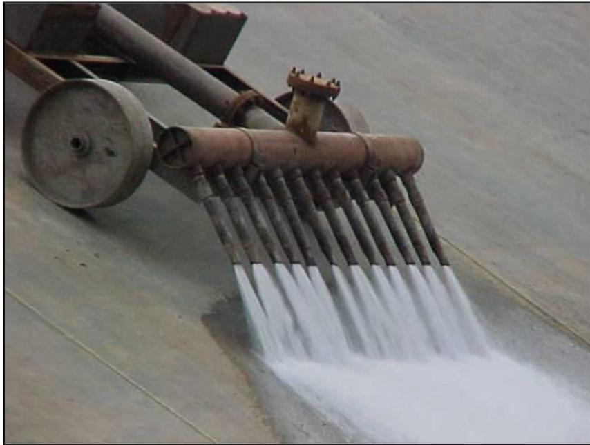
**Figura 29.24.-** Detalle de los chorros a presión proyectados por la barredora.
