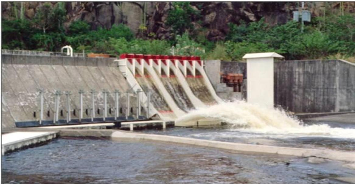
**Figura 7.19.-** Modelo hidráulico, a escala 1:50, construido a principios de 1980 en las instalaciones de EDELCA en la zona del proyecto, (Cortesía del Ing. Arturo Marcano).
