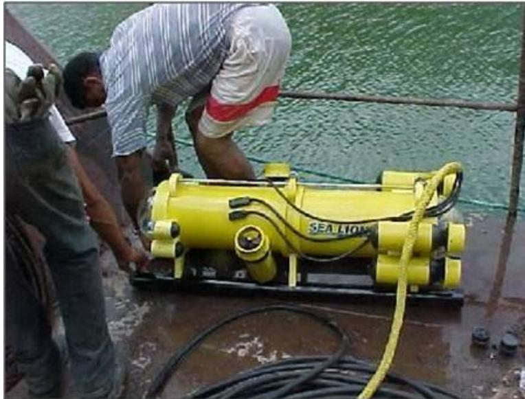
**Figura 29.21.-** Minisubmarino (ROV). (Cortesía del Ing. Carlos Pimentel).
