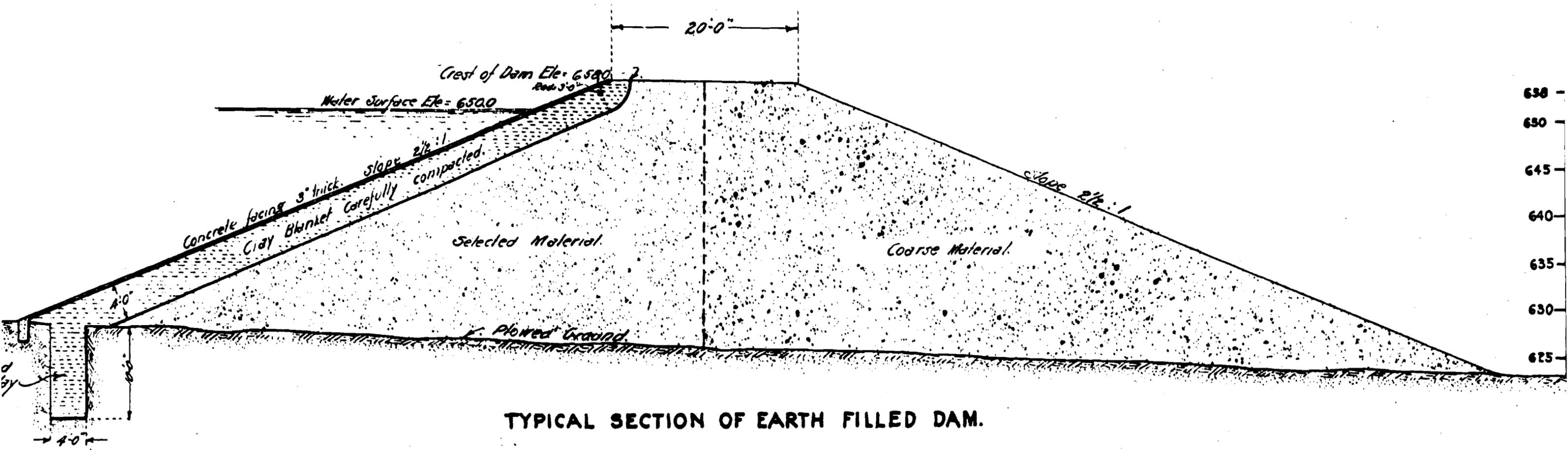
TYPICAL SECTION OF EARTH FILLED DAM.
